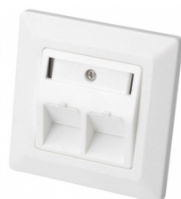
DN-93801-1 Poklopac pogodan za sve DIGITUS Keystone module. Integrirani poklopci za zaštitu od prašine osiguravaju optimalnu zaštitu. Oni imaju kosi izlaz za vertikalni smer od 45 ° (nemački i britanski izgled) ili 90 ° horizontalni smer umetanja (francuski raspored).
